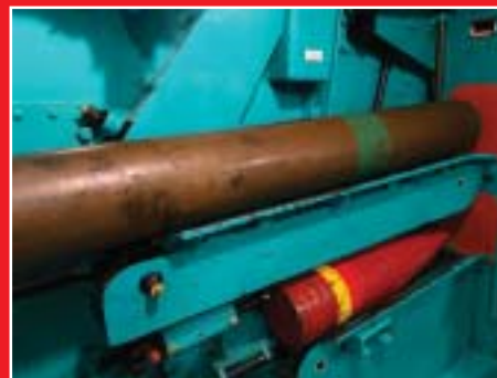
Halvpansargranat och hylsa. Hylsan innebär att pjäsen har kilmekanism
